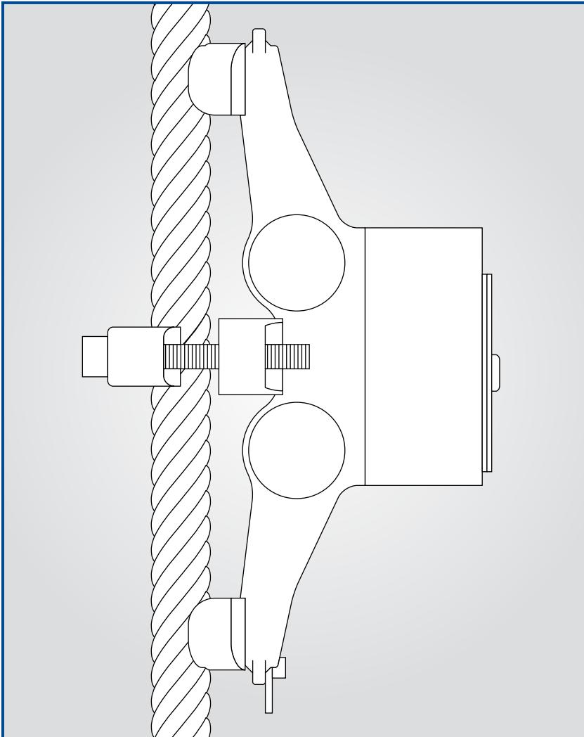
ボルトを締める時は、両方のボルトに同一のトルクをかけるようにしてください。
