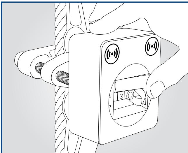
**必ず安全な場所で作業してください。** BOLTの電池カバーをマイナスドライバーで取り外し、電池を入れたらカバーを元に戻します。BOLTは通常のハンドヘルディスプレイのほか、防爆仕様のハンドヘルドディスプレイSW-HHP-ATEX、荷重管理ソフトウェアと接続することもできます。詳細についてはマーテックまでお問い合わせください。
