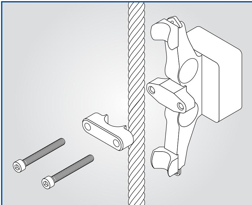
M10ボルト×2個を取外して図のようにBOLT本体をロープ下部にセットし、上側から
