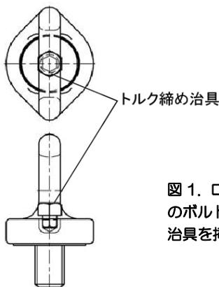
図 1. ロータリーアイボルトのボルト六角穴にトルク締め治具を挿入した状態
